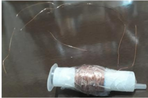
Figura 6 - Enrolamento de 600 espiras ao longo do comprimento da seringa.
