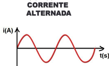
Figura 15 - Gráfico i(A) x t(s) da corrente elétrica alternada.
