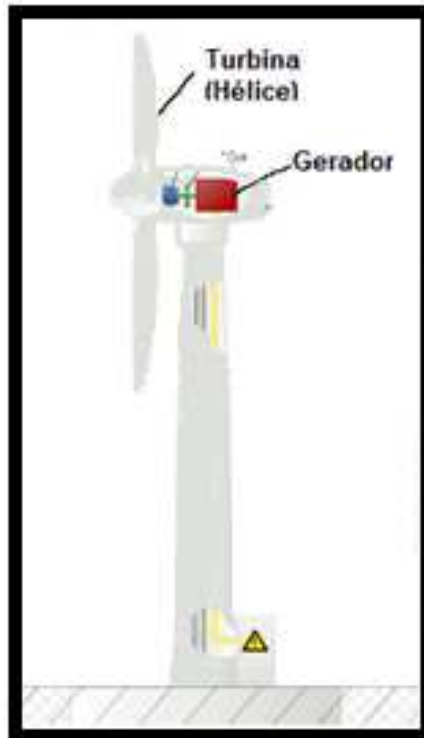
Figura 51 - Unidade eólica onde pode ser visto a turbina(hélice) e o gerador.
