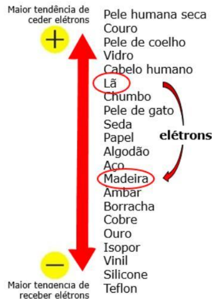
Figura 12 - Série Triboelétrica. Tendência de os materiais cederem e de receberem elétrons.
