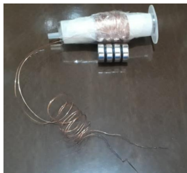
Figura 7 - Enrolamento na seringa e 4 ímãs de neodímio.
