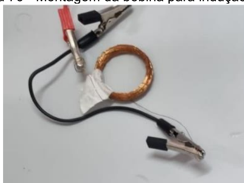
Figura 76 - Montagem da bobina para indução de CA
