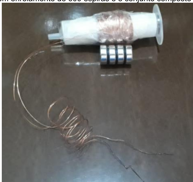
Figura 69 – Seringa com enrolamento de 600 espiras e o conjunto composto por 4 ímãs de neodímio
