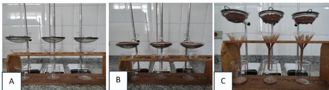
Figura 4 – Sistema montado para análise de derretimento (béquer, funil, suporte e peneira) para análise de derretimento (A); Início da análise dos três tratamentos (B); e Sorvetes em processo de derretimento, após 60 minutos de análise (C)
