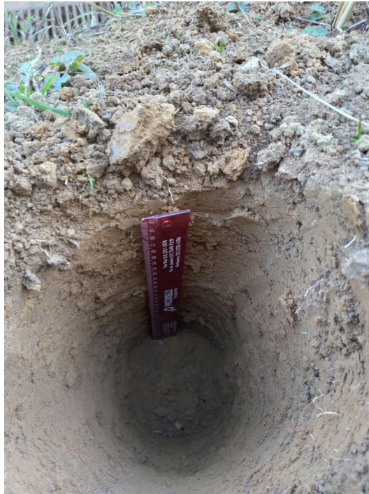
Figura 16 - Retirada da amostra deformada de solo na profundidade 0 a 30 cm
