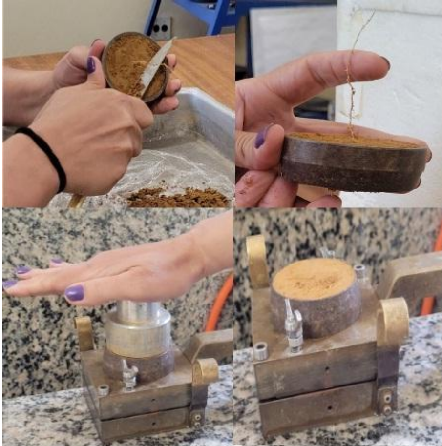
Figura 19 - Preparo, moldagem e montagem da caixa de cisalhamento
