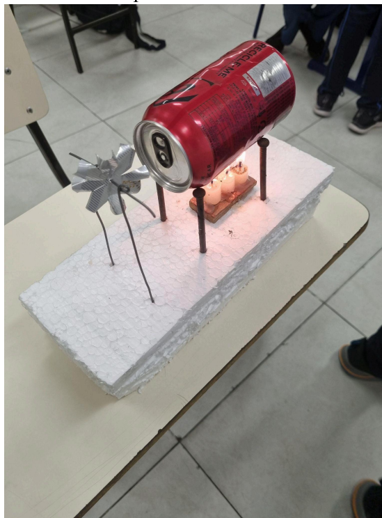
Figura 13 – Execução da Usina Termelétrica utilizando a base de isopor e a ventoinha feita somente com uma parte de uma lata
