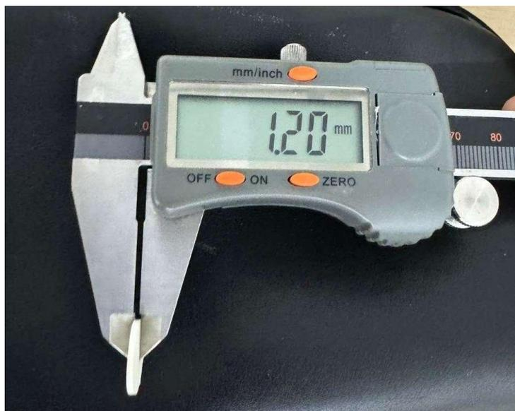
Figura 4 — Espessura final do disco de cerâmica de silicato de lítio reforçado com zircônia.
