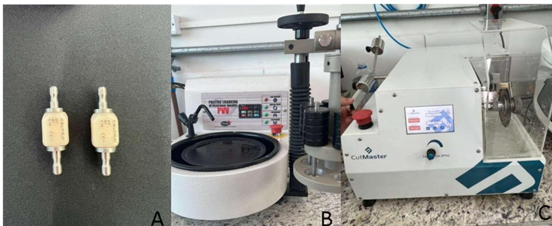
Figura 3 — Confeção dos discos cerâmicos. A) Blocos de cerâmica de silicado de lítio reforçado com zircônia, acoplados à dispositivo metálico de outra cerâmica CAD/CAM para facilitar o arredondamento em lixadeira; B) lixadeira Politriz Metalográfica de Velocidade Variável PVV; C) máquina de corte de precisão CutMaster.
