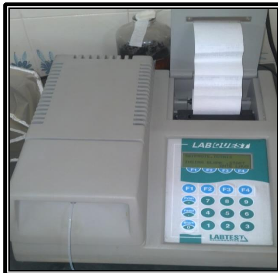
Figura 21. Analisador bioquímico utilizado para avaliar os parâmetros bioquímicos no soro dos animais do experimento in vivo . Fonte: Laboratório Santarosa de Análises Clínicas (Andrelândia/MG). Foto: Autor (2013).
