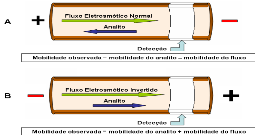
Figura 9: Representação esquemática dos modos de operação em eletroforese capilar. A) contra-eletrosmótico; B) co-eletrosmótico. Fonte: GONÇALVES FILHO, 2007.
