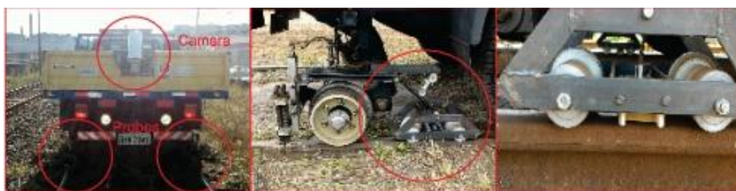
Figura 27: Sondas instaladas no veículo de inspeção. Na esquerda é possível visualizar a câmera; no centro é mostrado o suporte de fixação da sonda; à direita pode ser visualizado detalhes do suporte da sonda.
