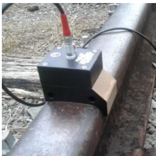
Figura 18: Sonda PT003, utilizada nesta configuração para os primeiros testes manuais
