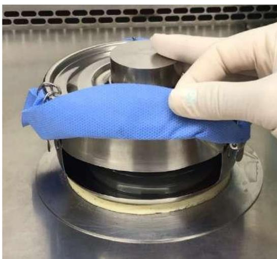
**Figura 4:** Recipiente de ensaio montado.
