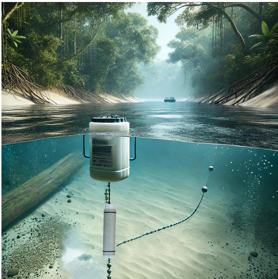
Figura 3,2 Esquema do sistema de amarração do F-POD, que inclui um flutuador, amarras ao flutuador e um peso.
