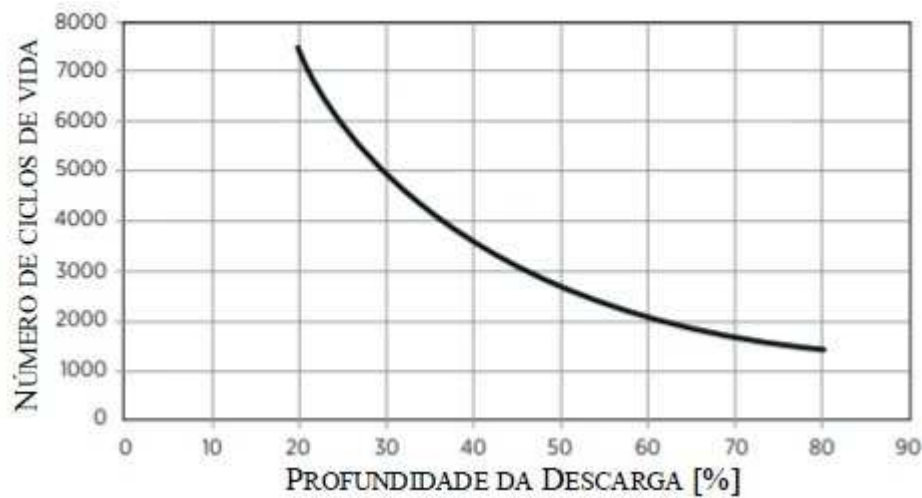
Figura 10 – Exemplo do efeito da profundidade de descarga na vida útil de uma bateria.
