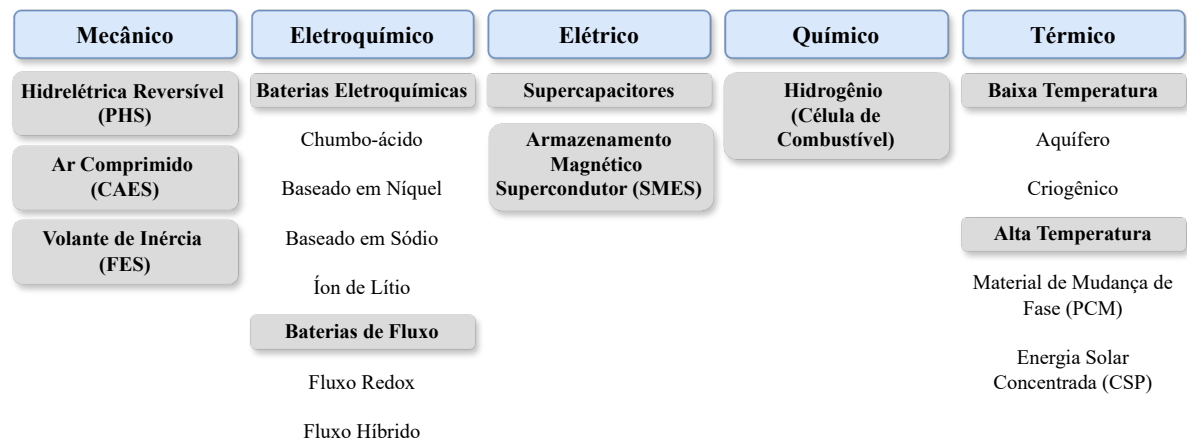
Figura 3 – Classificação das tecnologias de armazenamento de energia pela forma de energia armazenada.
