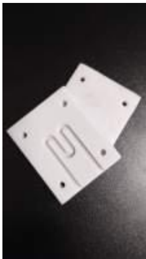
(a) Molde em resina fotopolimerizável.
