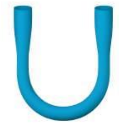
Figura 4.8 – Esquemático fibra com curvatura controlada U
