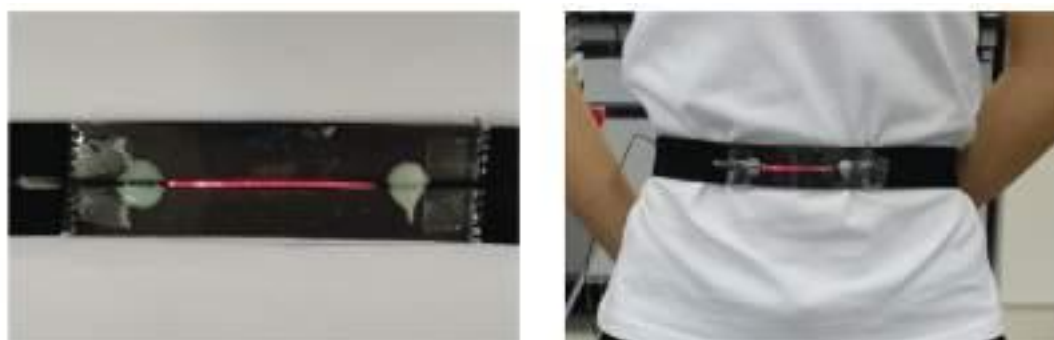
Figura 4.17 – Sensor vestível baseado em POF com geometria em D para monitoramento respiratório proposto por {39}.
