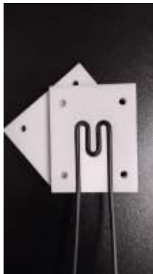
(b) Fibra posicionada no molde.
