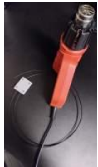
(c) Aquecimento e conformação da fibra.
