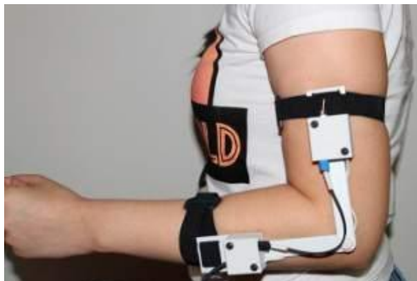
Figura 3.1 – Goniômetro baseado em POF proposto por Rezende et. al. {24}.
