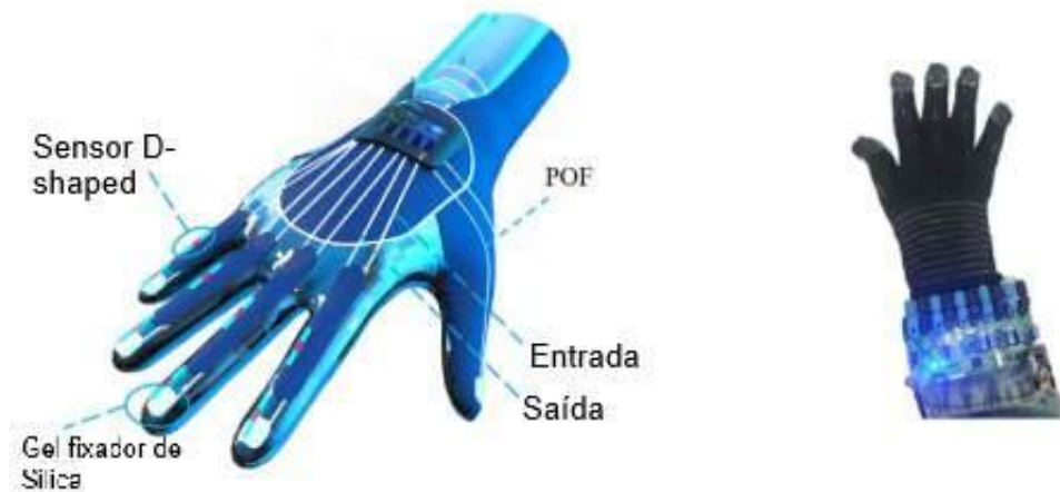
Figura 3.4 – Smart-luva baseado em POF proposto por {16}
