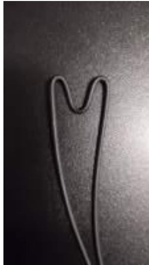
Figura 5.8 – Sensor em sua forma bruta, sem encapsulamento.
