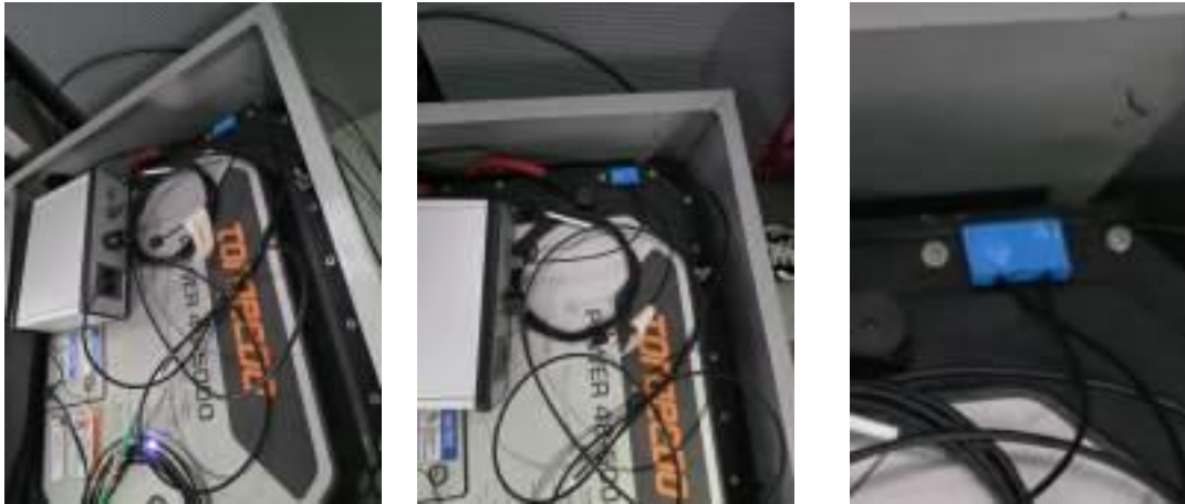
Figura 5.2 – Aplicação do sensor óptico em geometria "W" para monitoramento da dilatação de baterias.
