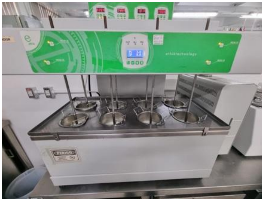
Figura 2 - Equipamento adaptado para alterações de temperatura com cubar com agitação individual.
