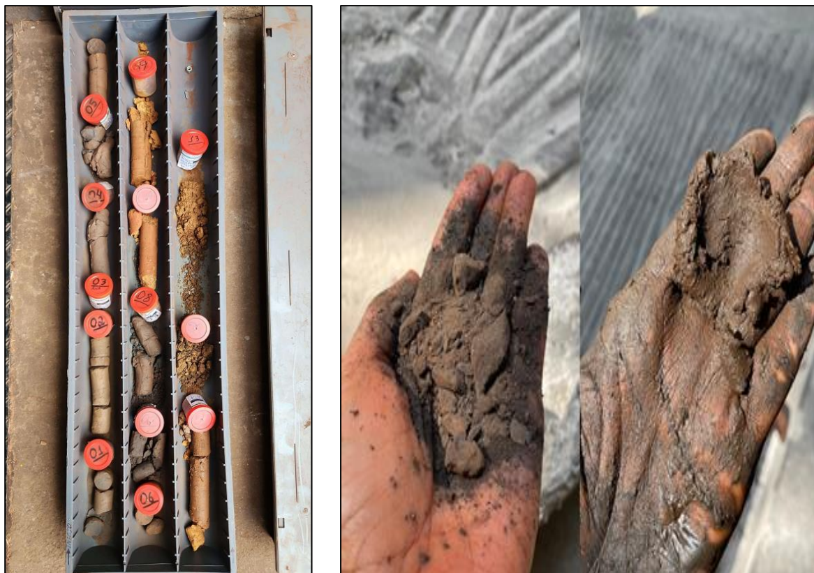
Figura 31 – Testemunho de sondagem e caracterização tátil visual – SP-02
