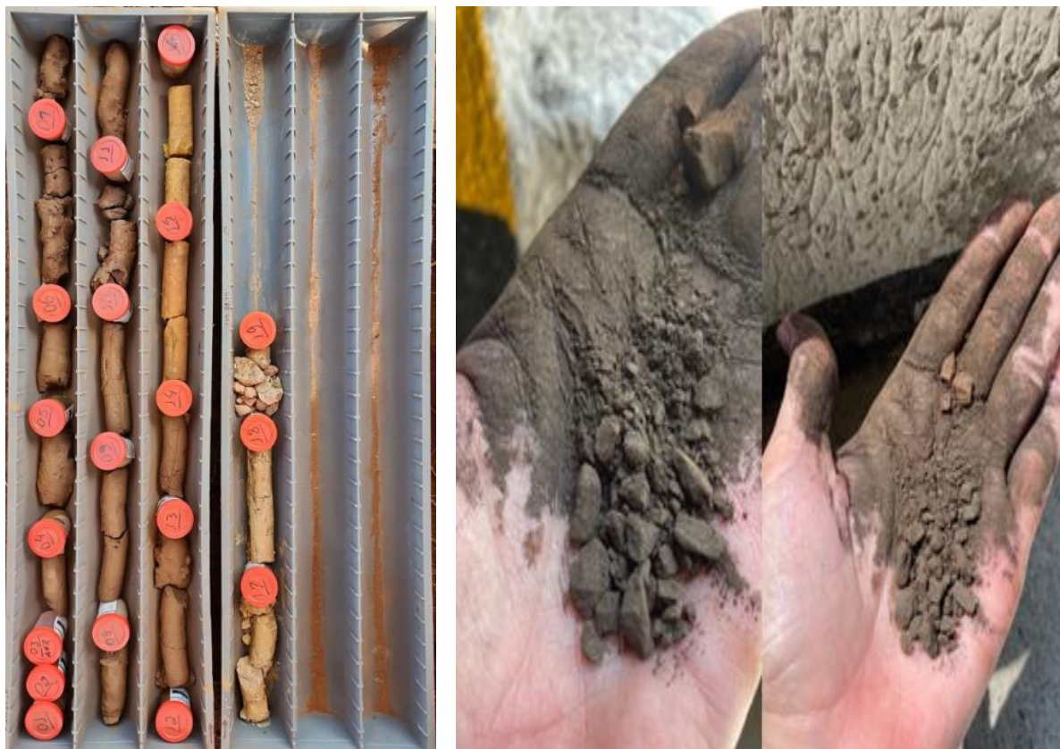
Figura 30 – Testemunho de sondagem e caracterização tátil visual – SP-01
