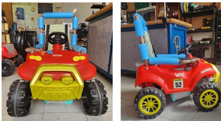
Figura 1 - Carrinho de brinquedo motorizado e adaptado pelo Projeto Adapt.
