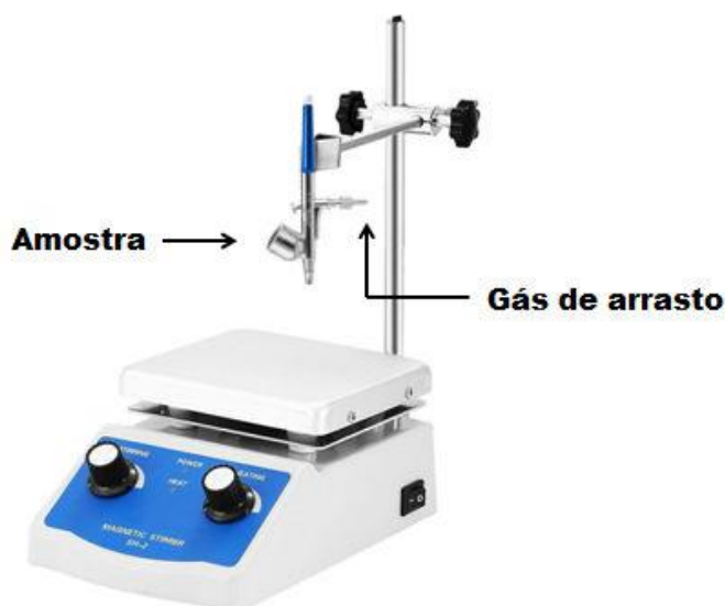
Figura 3.20: Deposição por sprayer esquematizada.
