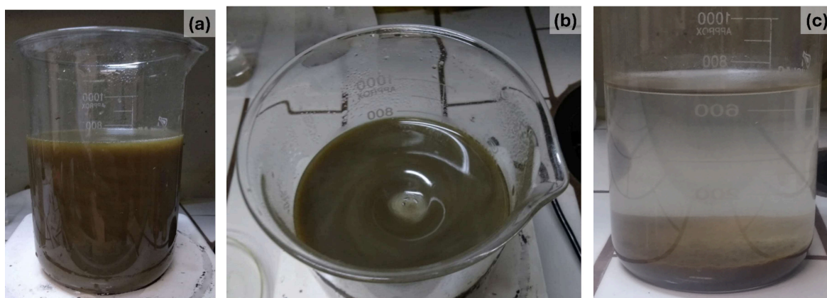
Figura 3.5: Final do processo de oxidação da síntese de HGO. (a) e (b) Dispersão amarelada ao adicionar o \text{H}_2\text{O}_2 . (c) Dispersão após 48 h de decantação.
