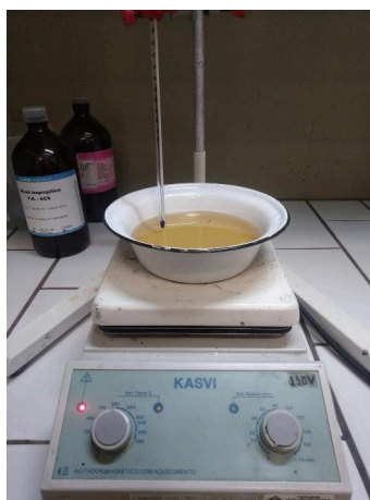
Figura 3.8: Banho de glicerina para redução do HGO com hidrazina.
