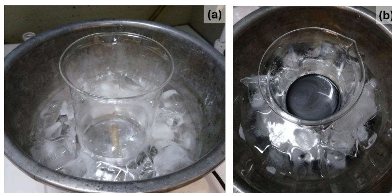
Figura 3.1: Primeiro banho de gelo da síntese do HGO - adição da água deionizada, ácido sulfúrico e grafite em pó. (a) Banho de gelo. (b) Dispersão cinza após adicionar água DI, \text{H}_2\text{SO}_4 e grafite em pó.
