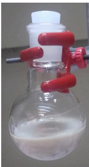
Figura 3.17: Coloide de AgNWs resfriado à temperatura ambiente após o final da síntese.
