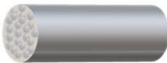
Figura 1.8: Esquema ilustrativo da estrutura do Nanofio de Prata.
