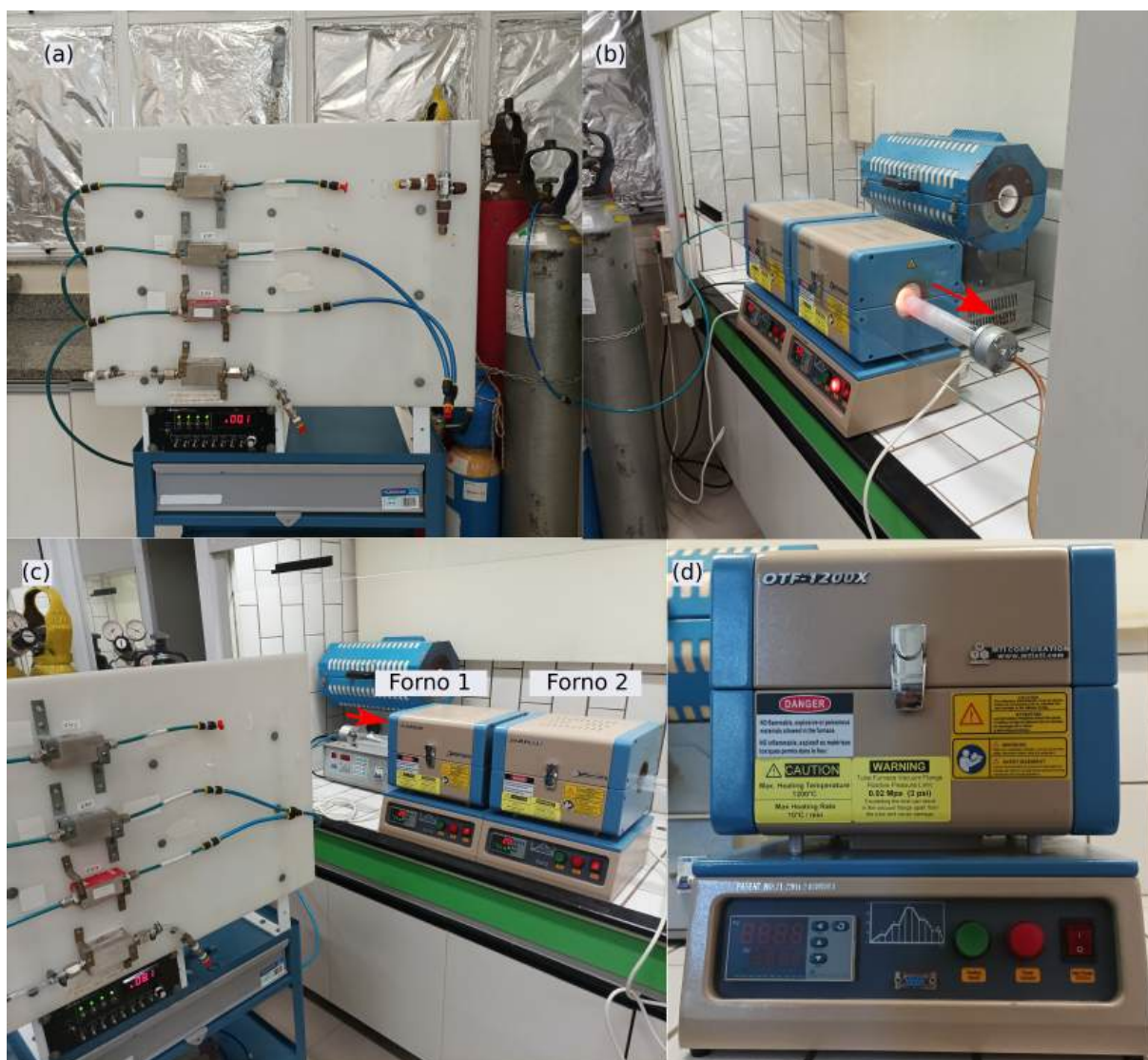
Figura 4.4 – (a) Fluxímetros utilizados para controlar os fluxos de gás utilizados durante a síntese. (b) e (c) Fornos elétricos que são usados para aquecer o sistema, onde, as setas vermelhas indicam a direção dos fluxos de gases, e a indicação dos fornos 1 e 2.(d) Visão de frente de um dos fornos utilizados.
