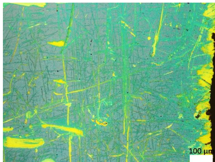
Figura 5.6 — Imagem de microscopia óptica do crescimento T3 (700°C). É possível observar a deposição de estruturas intermediárias (tons amarelados, por exemplo) próximas da borda do substrato de silício.
