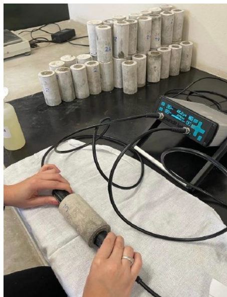
Figura 32 - Ensaio de Velocidade de Pulso Ultrassônico.
