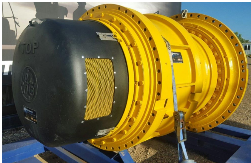
Figura 2.7 – Motor de corrente contínua utilizado no Komatsu 730E (Fonte: https://www.minespecparts.com.au/product/komatsu-730-wheel-motor/ ).
