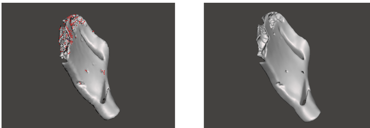
Figura 9 - Modelo da guia orgânica em STL que passou pelo processo de correção de malha no MeshMixer.
