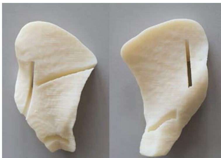
Figura 8 - Guia cirúrgica impressa em filamento ABS.
