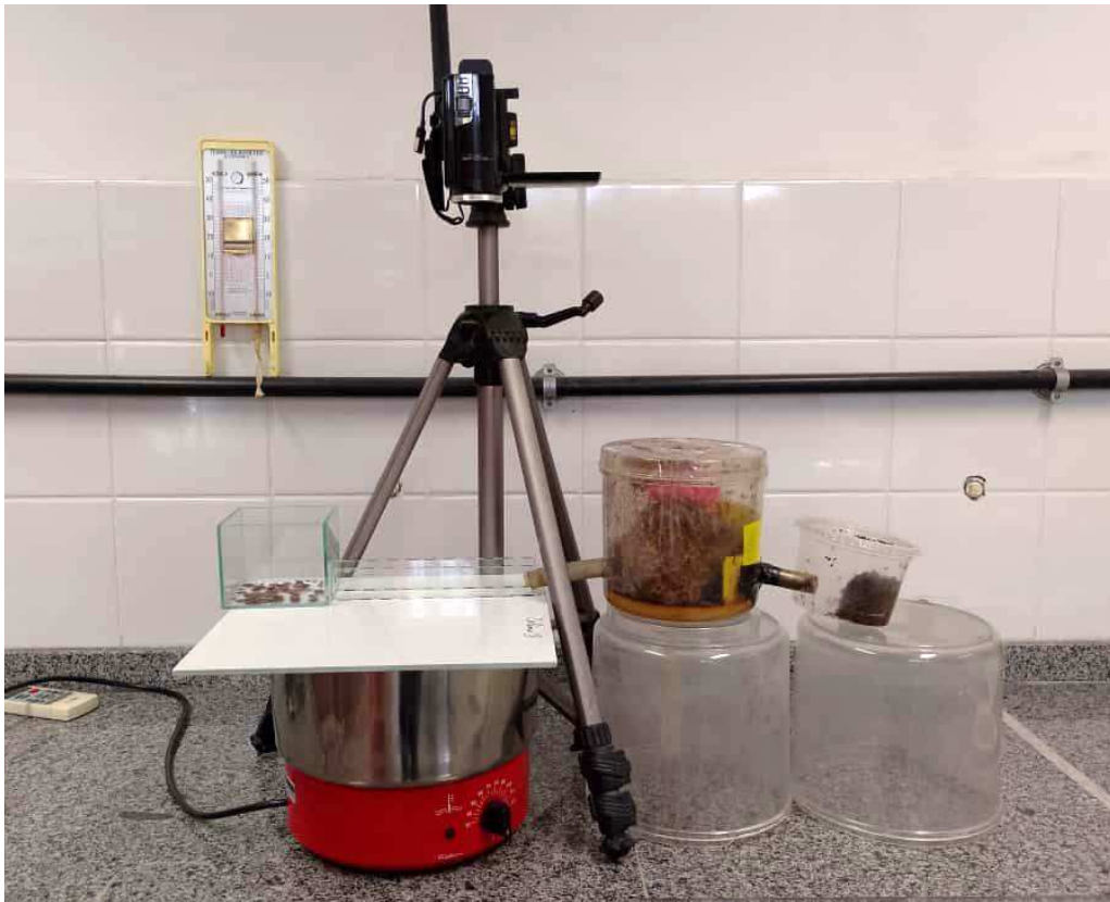
Figura 1 – Sistema experimental composto pela colônia com jardim de fungo e câmara de lixo conectada à trilha de forrageamento, aquecida por banho-maria elétrico, e arena com discos de Acalypha wilkesiana . Perpendicular à trilha, a câmera Sony HDR-XR260 utilizada para a filmagem.
