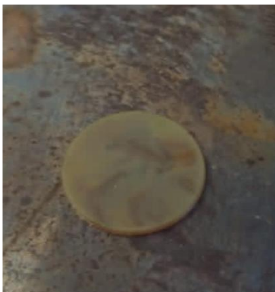
Figura 5.1 – Vidro que não deu certo durante o processo de recozimento. Fonte: Autor
