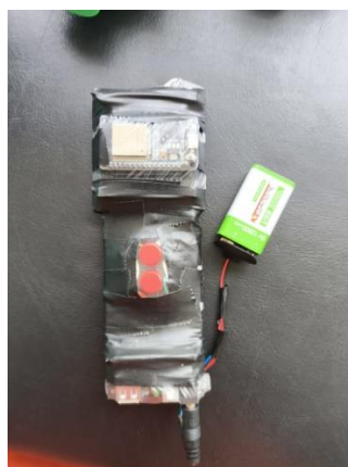
Figura 12 – Controle de comando do TSM visual Fonte: Foto retirada pelo Departamento de Engenharia Elétrica da UFJF (2025)
