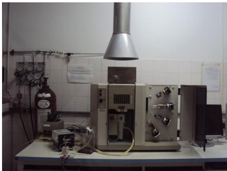
Ilustração 6. Espectrômetro de absorção atômica Spectra AA-220-Fast Sequencial (Varian, Austrália). Fonte: a autora.
