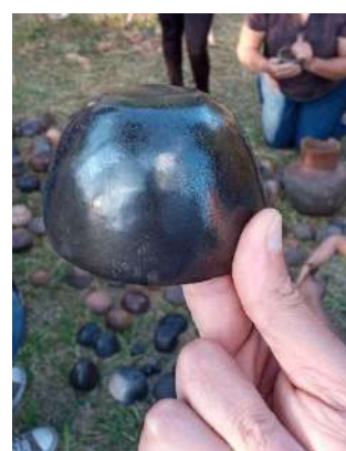
À esquerda e ao centro: peças que foram quebradas após a queima, evidenciando diferentes resultados da queima, com variação na formação de “coração negro”. À direita: peça polida e enegrecida, que foi queimada dentro de uma lata (“mufla” improvisada). Foto: Cristiano Lima, 21 de julho de 2025
