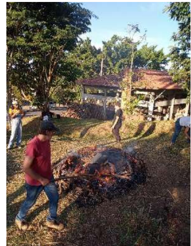
Registros do “esquente”, do posicionamento das peças no centro da concavidade e do início da queima em fogueira feita no entorno do Laboratório Escola de Cerâmica da UFSJ. Fotos: Cristiano Lima, 18 de julho de 2025
