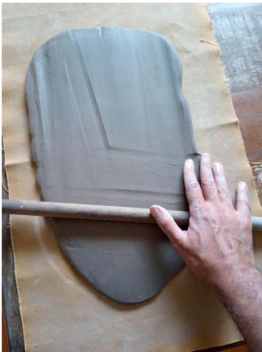
Abertura de placa de argila com cabo de madeira torneada, para ser utilizada na produção de peças de cerâmica. Foto: Cristiano Lima, 2024
