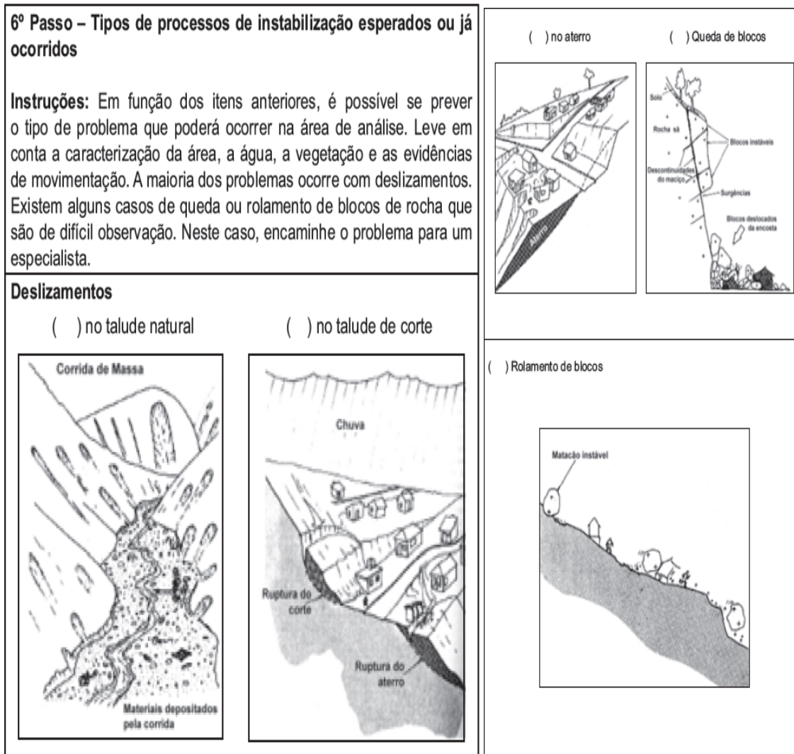
Figura 11 – Tipos de processos de instabilização (MINISTÉRIO DAS CIDADES, 2007)
