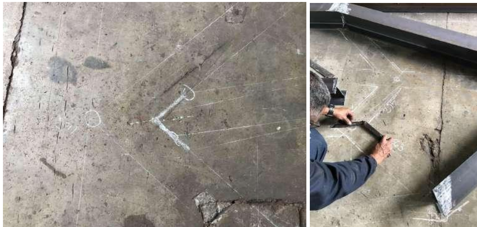
Figura 11— Desenho dos módulos da escultura feito no chão do galpão para facilitar a montagem
