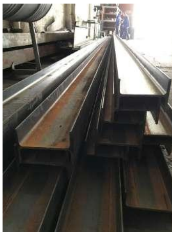
Figura 05 — Barras de perfil “I” já armazenadas no galpão
