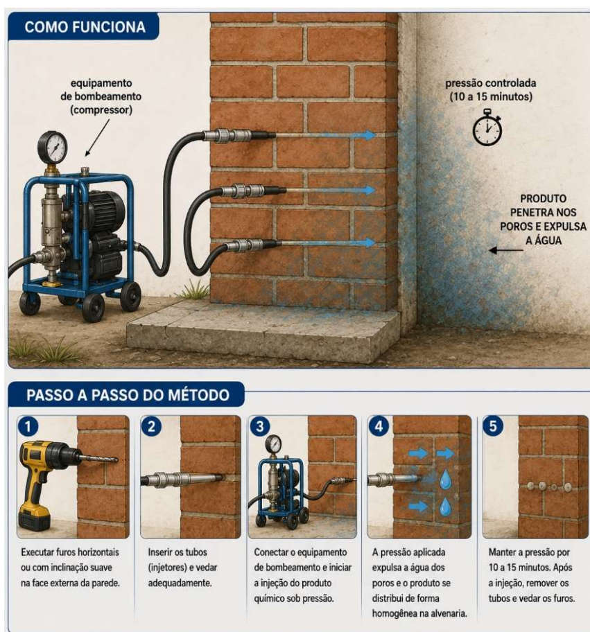
Figura 17 - Representação esquemática do método injeção química sob pressão.
