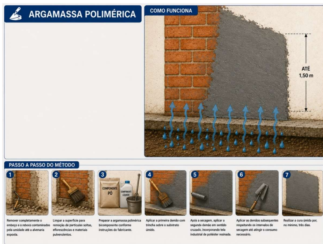
Figura 21 - Representação esquemática de aplicação de argamassa polimérica.
