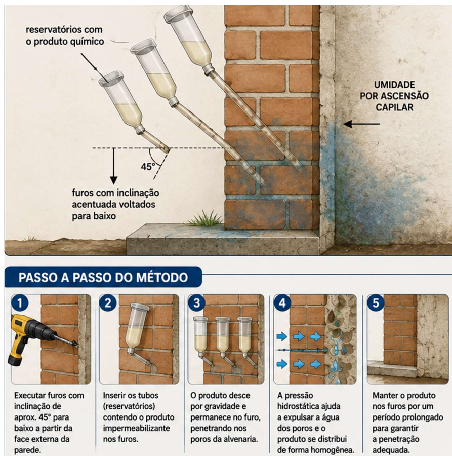
Figura 16 - Representação esquemática do método injeção química por gravidade.
