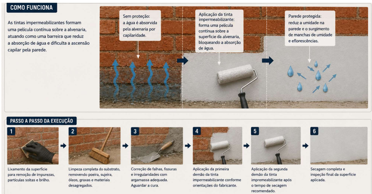
Figura 20 - Representação esquemática do método de membranas impermeabilizantes.
