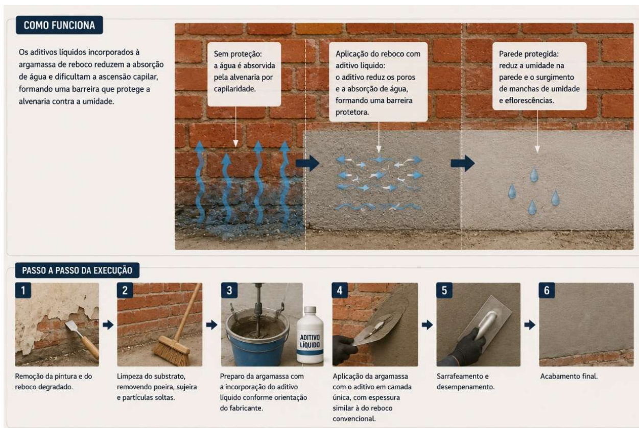
Figura 19 - Representação esquemática do método argamassas com aditivos líquidos.
