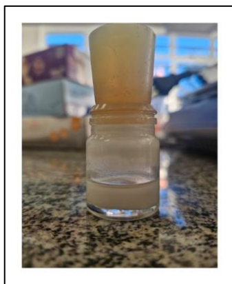
Figura 8 – Eletrólito 1:1 MLCC-THF logo após 8h de agitação.
