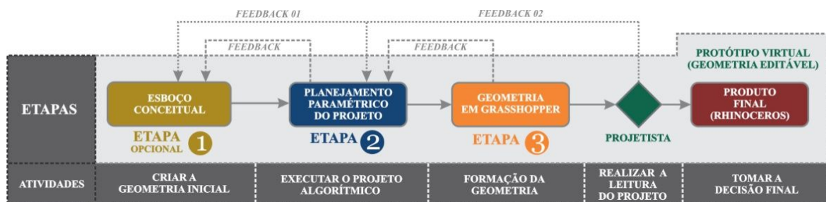
Figura 59 – Estratégias processuais que podem ser adotadas para os SGP (com ou sem a etapa do esboço conceitual)
