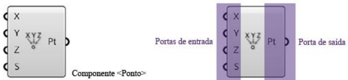
Figura 10 – Representação de um componente com suas portas de entrada e saída
