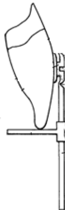
Figura 6 - Vista lateral do posicionador de bráquetes ortodônticos suportando bráquete e determinando posição.
