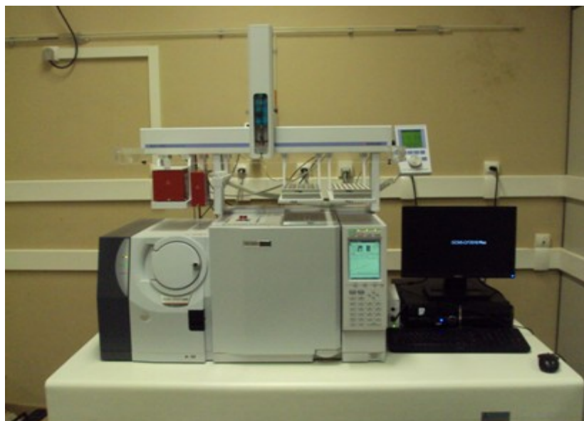
Figura 33. Cromatógrafo gasoso Shimadzu/GC2010, acoplado ao espectrômetro de massas também da Shimadzu modelo MASS QP2010 Plus, Injetor Automático AOC5000, pertencente à Central Analítica do Departamento de Química da UFJF.
