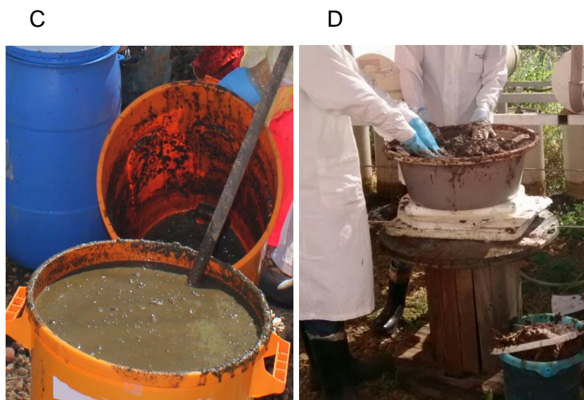
Figura 4. Realização da diluição C e separação de sólidos/peneiramento dos dejetos D.
