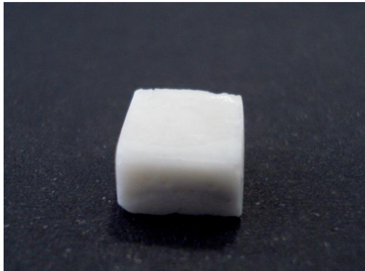
Fig1-a) Bloco cerâmica com dimensões de 4,5 x 8 x 7mm
