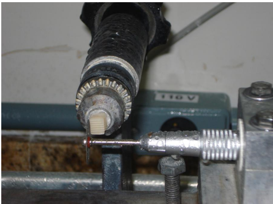
Figura 4- Bloco posicionado com superfície adesiva perpendicular ao disco de diamante
