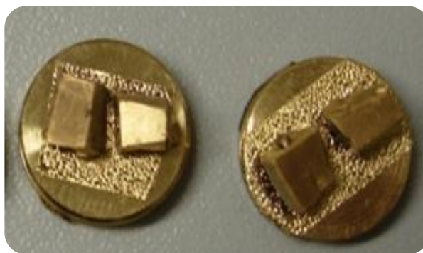
Figura 5: Foto mostrando os corpos de prova metalizados com ouro-paládio.
