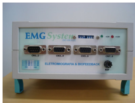
Figura 6 – Condicionador de sinais de oito canais da EMG System ® , utilizado para aquisição de sinais de eletromiográficos e curvas força-tempo.
