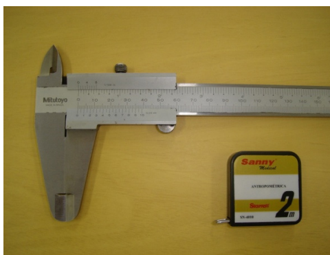
Figura 3 – Equipamentos para aferição. Paquímetro da Mitutoyo ® com capacidade de 300 milímetros (mm) e precisão de 0,05 mm e fita métrica inextensível da Sanny ® , modelo SN-4010 com graduação em centímetros.
