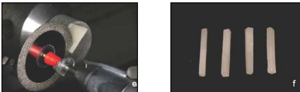
Figura 12 – Sequência da preparação dos cp para o ensaio de tração com amostras reduzidas: e) corte da fatia para obtenção das amostras (área reduzida); f) amostras obtidas.
