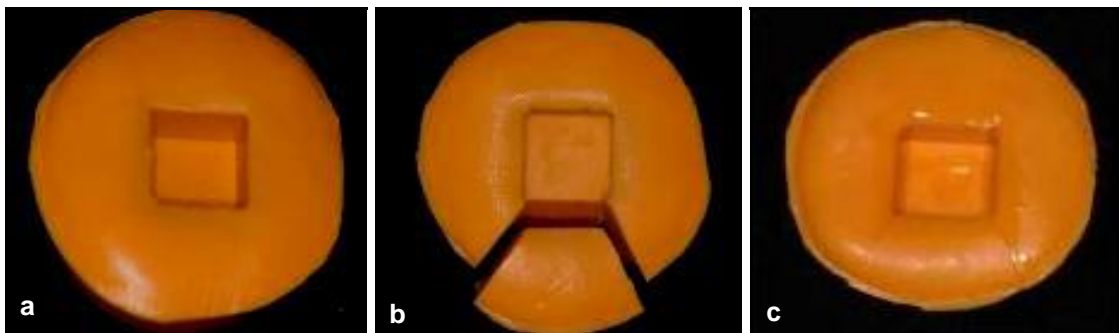
Figura 4 – Seqüência de confecção dos blocos cerâmicos: a) moldagem do padrão; b) secção do molde; c) molde isolado com óleo mineral.
