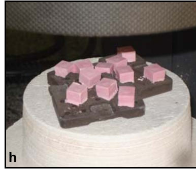
Figuras 4g e 4h – Blocos cerâmicos no forno antes da sinterização.
