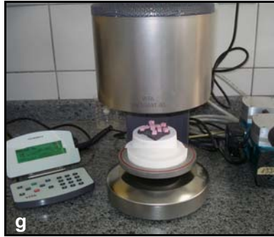
Figuras 4g e 4h – Blocos cerâmicos no forno antes da sinterização.
