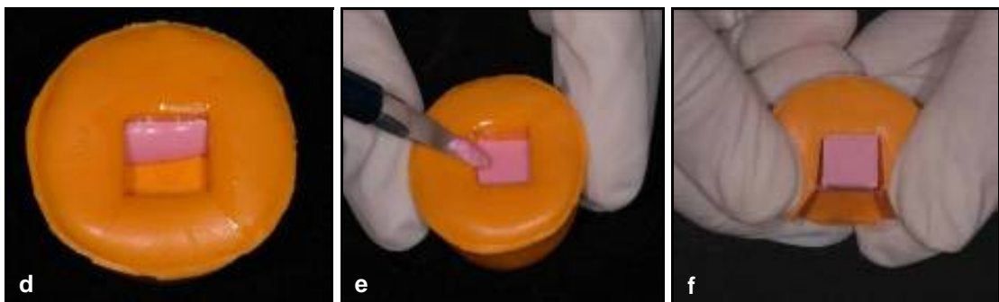
Figura 4 – Seqüência de confecção dos blocos cerâmicos: d e e) inserção e condensação da massa; f) remoção do bloco cerâmico.
