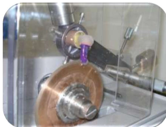
Fig. 4: Corte dos dentes no sentido longitudinal na máquina Labcut 1010
