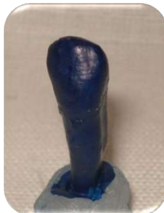
Fig. 2: Impermeabilização dos corpos de prova
