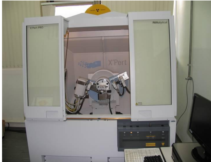
Figura 9 – Difratorômetro de raio-X (LAS-INPE).
