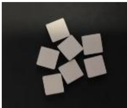
Figura 01 – Amostras sinterizadas de cerâmica Y-TZP (IPS e.max® ZirCAD – Ivoclar-Vivadent)
