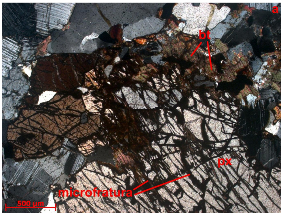
Figura 36 – Fotomicrografia em luz transmitida / nicóis cruzados da amostra 16 identifica a presença de microfaturas preenchidas por hidróxido/óxidos de ferro e biotita.
