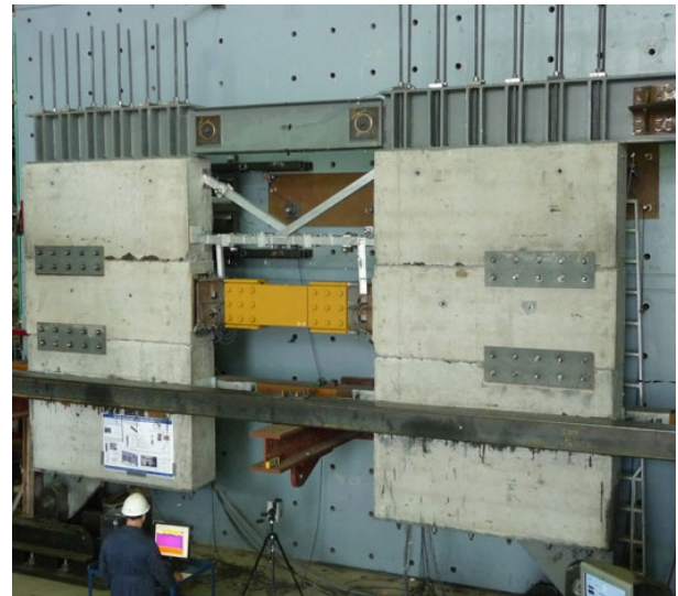
(b) Amortecedor instalado na estrutura para ensaios de laboratório.
