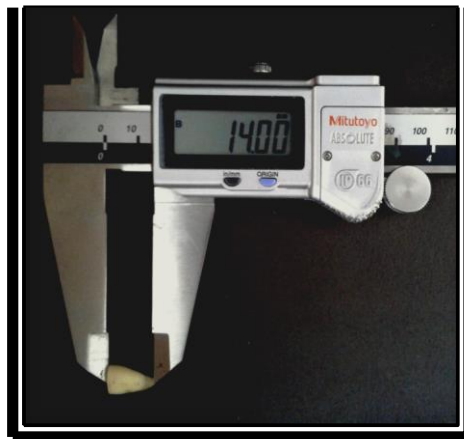
Figura 2: Paquímetro digital ABSOLUTE IP66 com precisão de \pm 0,02\text{mm} (Mitutoyo ® Sul Americana, São Paulo, Brasil) usado para conferir a padronização das raízes com 14mm.
