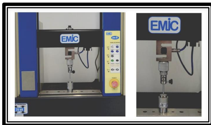
Figura 9: Máquina de teste universal (Emic DL 2000) (São José dos Pinhais, Paraná, Brasil) com dispositivo para push out (Odeme Dental Research, Luzerna, Santa Catarina, Brasil) acoplado.
