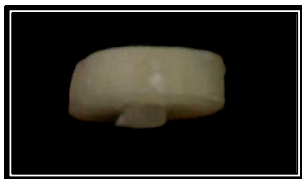
Figura 11: Pino deslocado após aplicação de carga.
