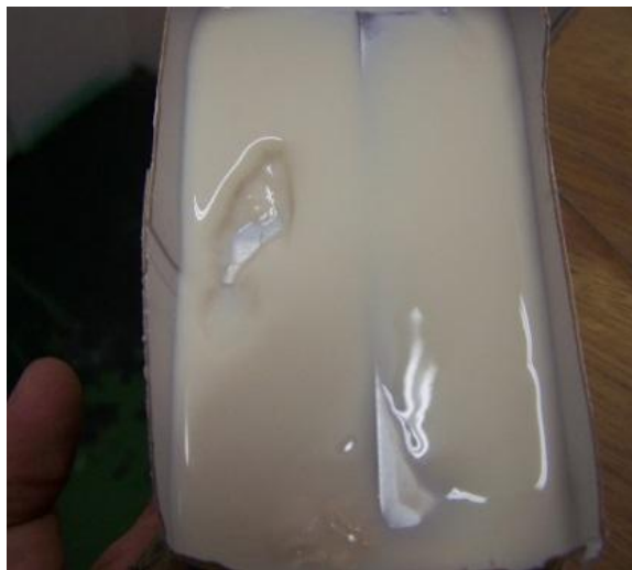
Figura 4: Precipitado com gelificação, 30 dias após envase.
