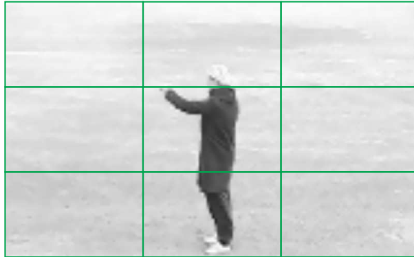
Figura 3.2: Exemplo de um quadro com nove partições. Cada partição gera um HOG.
