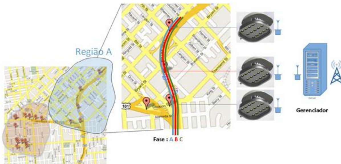
Figura 22 - Diagrama de distribuição das luminárias às fases da rede elétrica em vários setores.
