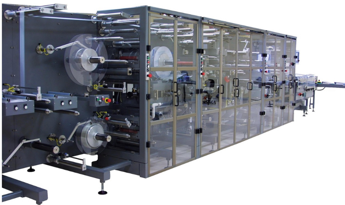
Figura 1. Equipamento industrial para fabricação de adesivos ( patches ) em larga escala.
