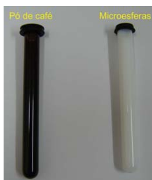
Figura 2.2. Tubos de pó de café e microesferas. No primeiro, destaca-se o efeito de absorção, enquanto no segundo o efeito de espalhamento é mais pronunciado.
