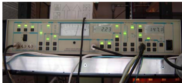
Figura 2.11. Amplificador lock-in SR510 usado neste trabalho.
