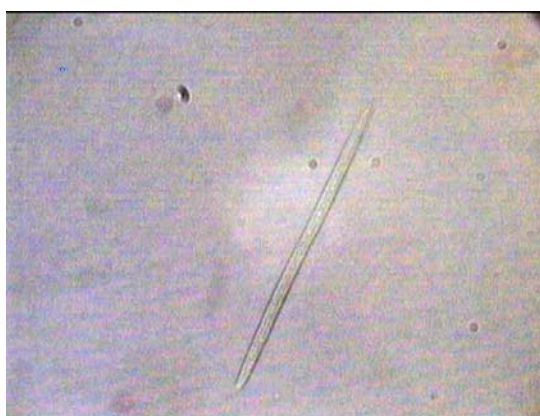
Figura 3.5. Filamento do tubo que sofreu 35 MCA de pressão.
