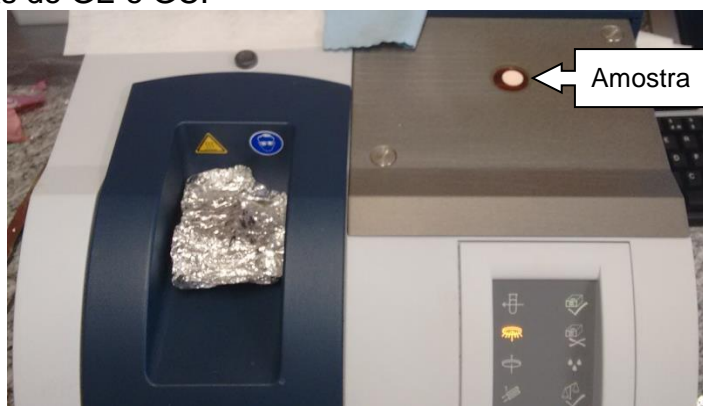
Figura 11 – Espectroscópio de Infravermelho utilizado na obtenção do espectro no NIR das amostras de GE e GC.
